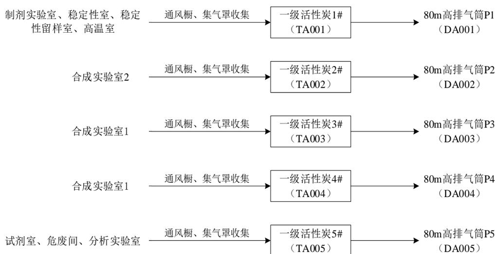
图 6-1 废气收集处理流程图
